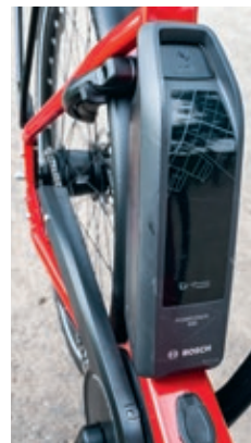
Der 500 Wattstunden fassende Bosch-Akku ermöglicht längere Radtouren
